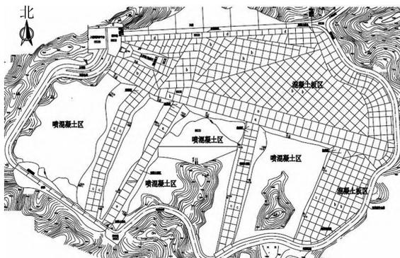
图1 回龙电站上水库防渗工程平面布置
