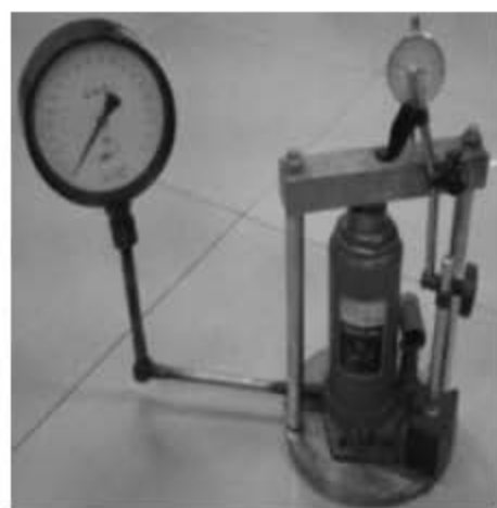
图2 二立柱框架的稳定性能试验
