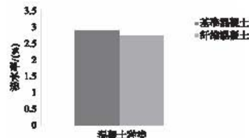
图4 水胶比为0.45混凝土泌水率比较
