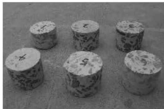
图1 混凝土取样照片
