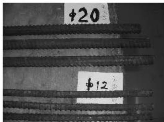
图2 钢筋取样照片
